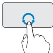
Pomičite prst u zoni za vodoravno pomicanje (krajnji desni dio površine osjetljive na dodir) kružnim pokretom u smjeru kazaljke na satu za pomicanje udesno ili suprotno od smjera kazaljke na satu za pomicanje ulijevo.
