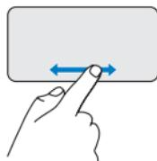
Pomičite prst gore ili dolje u zoni za vodoravno pomicanje (krajnji donji dio površine osjetljive na dodir) za pomicanje lijevo ili desno unutar aktivnog prozora.
