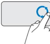
Pomičite prst u zoni za okomito pomicanje (krajnji desni dio površine osjetljive na dodir) kružnim pokretom u smjeru kazaljke na satu za pomicanje nagore ili suprotno od smjera kazaljke na satu za pomicanje nadolje.
