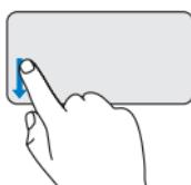
Pomičite prst nadolje u zoni za zumiranje (krajnji lijevi dio podloge osjetljive na dodir) za smanjivanje.
