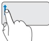
Pomičite prst nagore u zoni za zumiranje (krajnji lijevi dio podloge osjetljive na dodir) za povećavanje.
