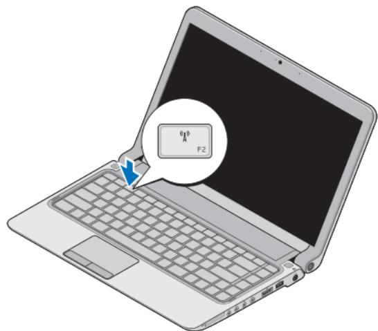
Za uključivanje bežičnog načina rada s uključenim računalom:
